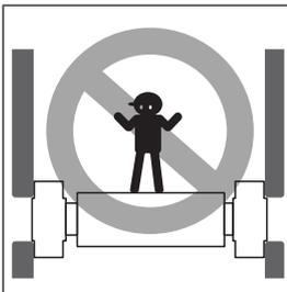
设置或调整时，施加负载请勿超过最大负载（额定负载的200%）。此外，作业时请勿将张力检测辊用作立足点。
